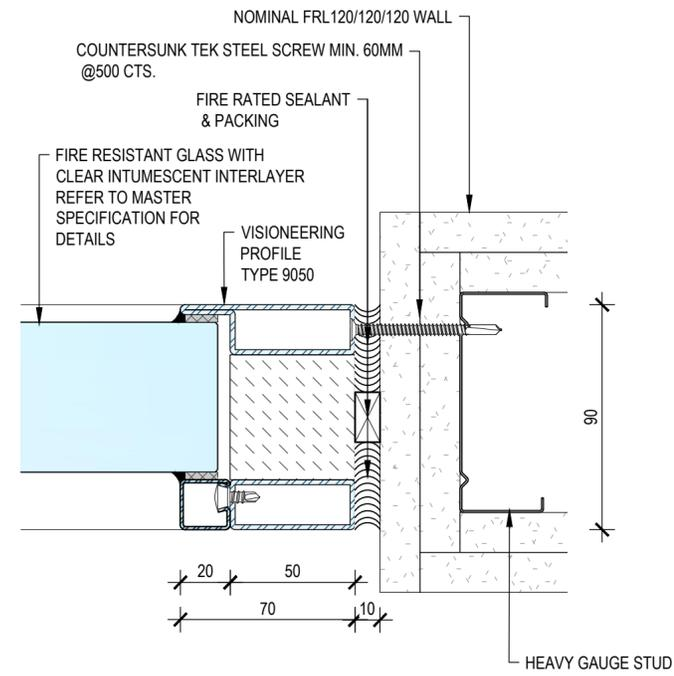
**2 JAMB DETAIL - CLAD STUD FIXING**
